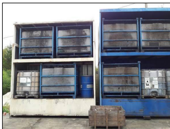
Stockage des huiles sur rétention
