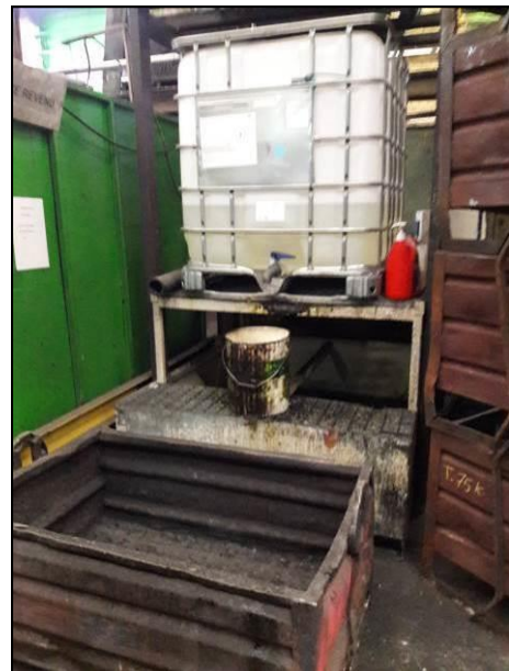
Stockage du polymère sur rétention
